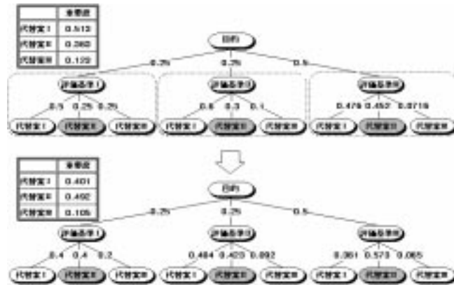
図 6 重み付けの調整の例 Fig.6 An example of adjusting weights
